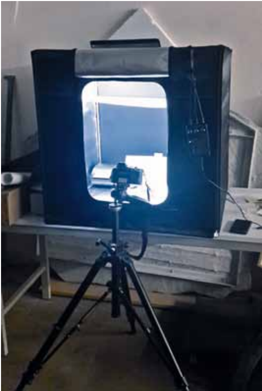
Abbildung 9. Die neue portable Fotostation in den Räumen der geowissenschaftlichen Sammlung erlaubt eine hochauflösende digitale Erfassung der Sammlungsobjekte. – Foto: M. SPISKE.
