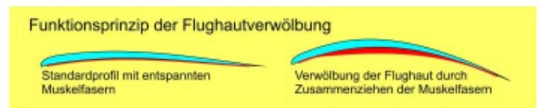
Abb. 25: Funktionsprinzip der Flughautverwölbung
